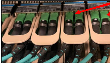
NVIDIA 9700 Switch con 2x NDR 400G Transceivers a 850nm
